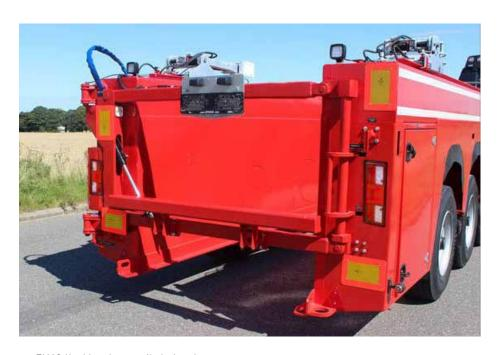
TM10 Heckleuchte vertikal eingebaut
