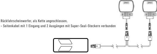
2 Ermax Rückfahr- oder Arbeitsscheinwerfer dürfen an eine Ermax Heckleuchte angeschlossen werden (max. 52 W)
