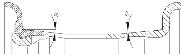
Aus Sicherheitsgründen ist unbedingt darauf zu achten, dass der passende, zugehörige, geschlitzte Seitenring (Kombiring) verwendet wird. Es wird empfohlen, den Trennspace des geschlitzten Seitenringes, bezogen auf den Ventilschlitz, mindestens 45° verdreht zu montieren.
