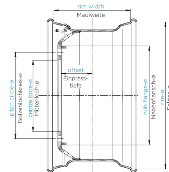
▼ reversible wheel, equipped with double ended valve reversibles Rad mit Doppelventil, beidseitig montierbar
